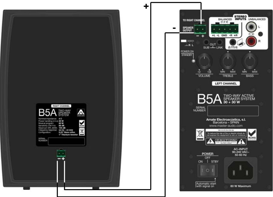
Fig.5. Conexión de recinto activo a recinto pasivo
