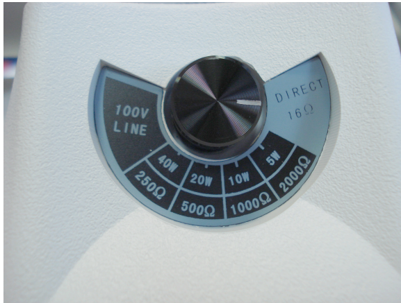
Fig.3. Selector de potencia B5/T y B6/T
