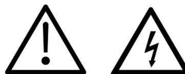
4. El signo de exclamación dentro de un triángulo indica componentes internos cuyo reemplazo puede afectar la seguridad.
