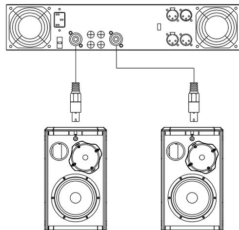
**Fig. 2.** Configuración Full-range estéreo
