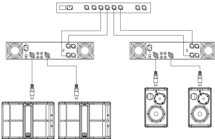
Fig. 6. Configuración bi-amplificada con subwoofer (opción 2)
