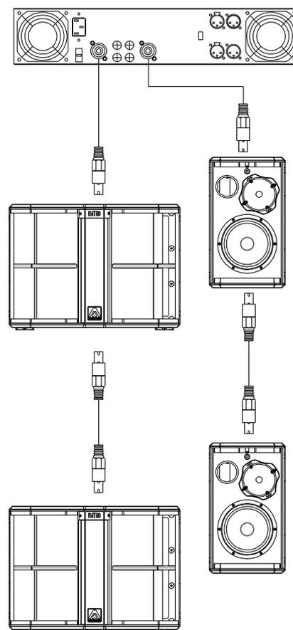
Fig. 5. Configuración bi-amplificada con subwoofer (opción 1)
