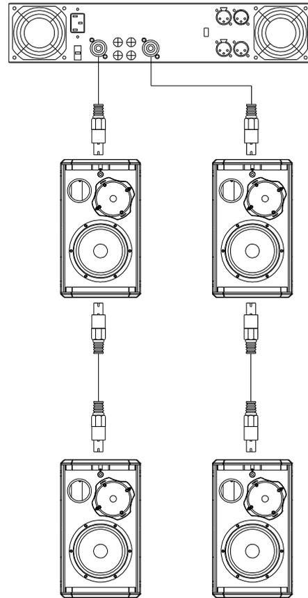
**Fig. 3.** Configuración Full-range estéreo en paralelo
