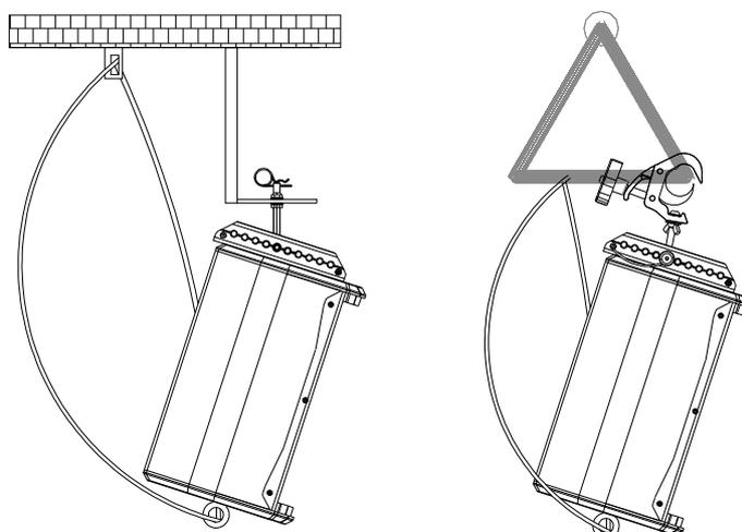
**Fig. 11.** Barra de volado RB-S y RB-S/GT para S6LP
